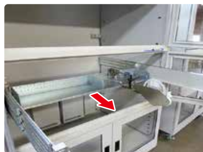
▲フィーダー取付棚板をスライド仕様に変更（取付棚板は各種メーカーに対応可能）
